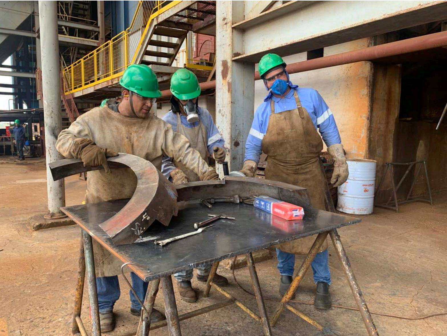
Percorrendo outras áreas da empresa, foi possível constatar diversos funcionários realizando o trabalho de manutenção, em especial operando substituição de peças novas e recondicionadas, dentre elas chapas de aço com nova pintura, reconstituição/ troca de engrenagens dos eixos, esteiras, correntes e demais componentes.
